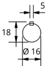
Detalhes Eixo de Saída Vazado
